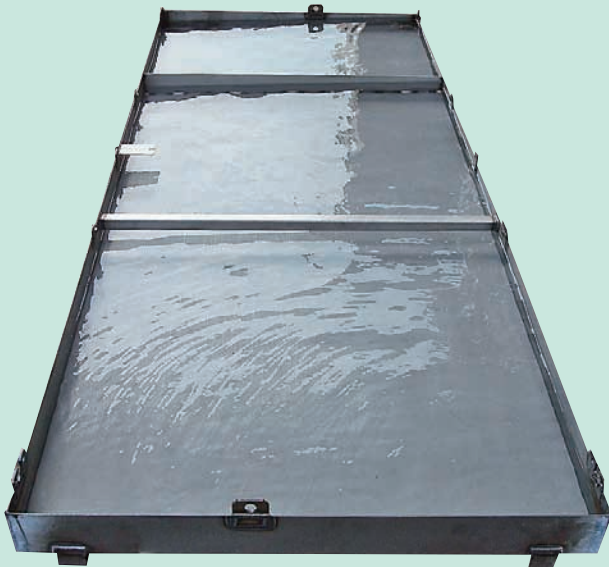
▲水張り検査工程
